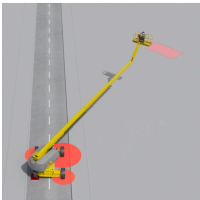
2. 当臂杆在水平位置旋转时, 最高负载位于最靠近平台的轮胎上
