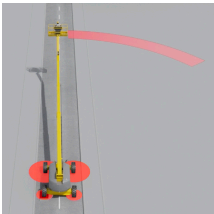
1. 当举升臂接近水平时, 最靠近平台的轮胎负载最大
