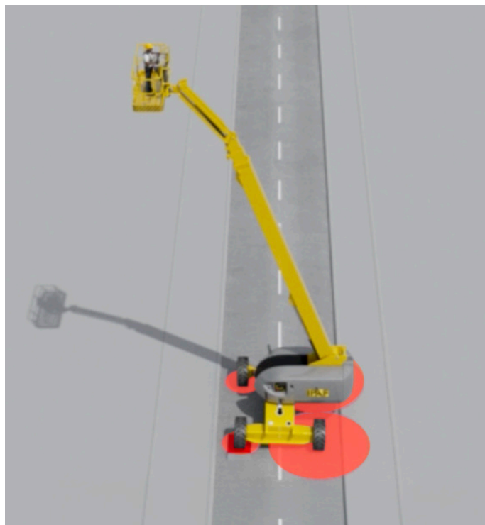
4. 收起和升高时, 最大负载位于配重正下方的两个轮胎上
