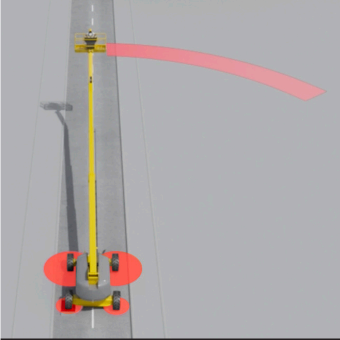
1. Bom yataya yakın olduğunda, en yüksek yük platforma en yakın lastikler üzerindedir
