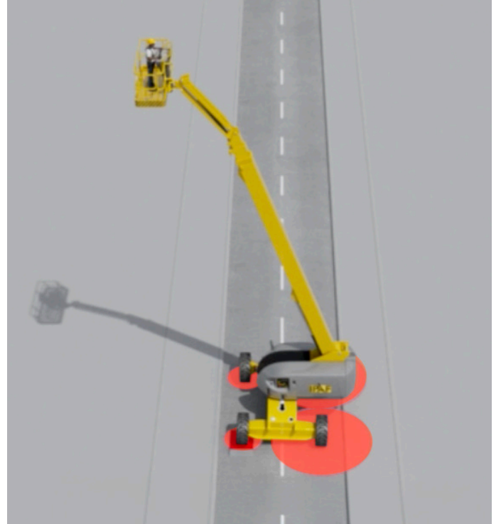
4. Geri çekildiğinde ve kaldırıldığında, en yüksek yük doğrudan karşı ağırlığın altındaki iki lastik üzerindedir
