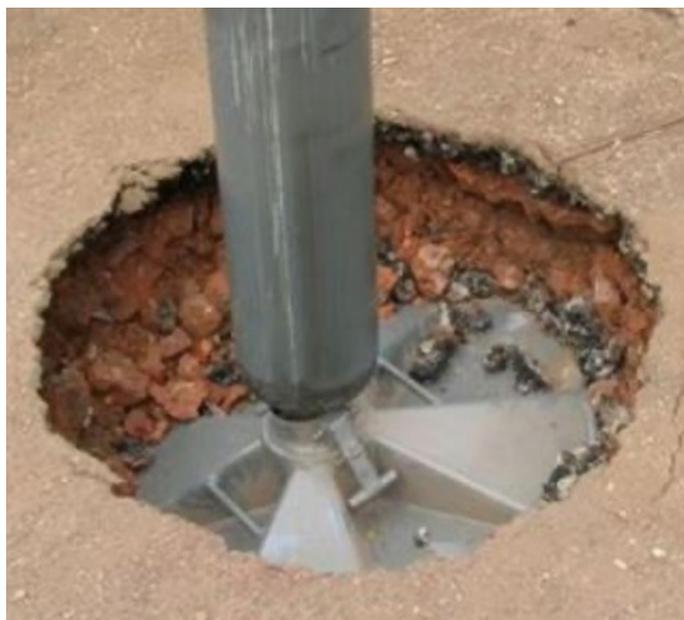
Exemplo de um pé de estabilizador sem uma placa de apoio (corte no solo).
