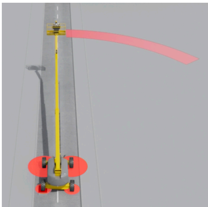
1. Quando il braccio è vicino all'orizzontale, il carico più alto è sugli pneumatici più vicini alla piattaforma
