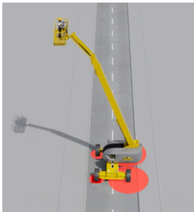
4. Quando represso e sollevato, il carico più alto è sui due pneumatici direttamente sotto il contrappeso
