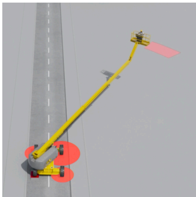
2. Mentre il braccio ruota in posizione orizzontale, il carico più alto è sul pneumatico più vicino alla piattaforma
