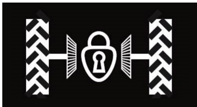
Esempio di decalcomania di bloccaggio del differenziale (Credit Niftylift)
