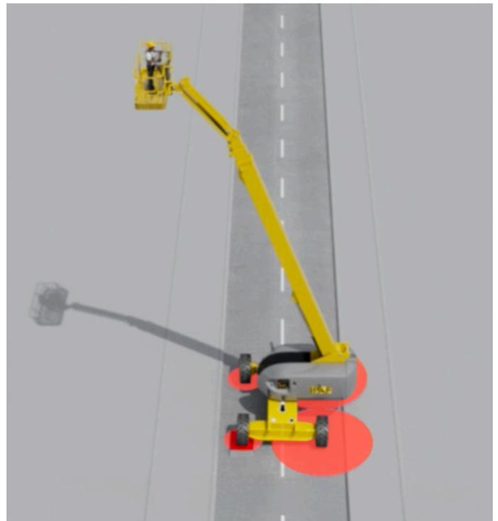
4. Beim Einfahren und Anheben ist die höchste Last auf den beiden Reifen direkt unter dem Gegengewicht
