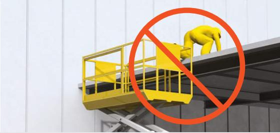
Las plataformas elevadoras móviles de personal (PEMP/PTA) están diseñadas específicamente para elevar a las personas a una posición en la que puedan realizar trabajos en altura de forma segura dentro de la plataforma.
