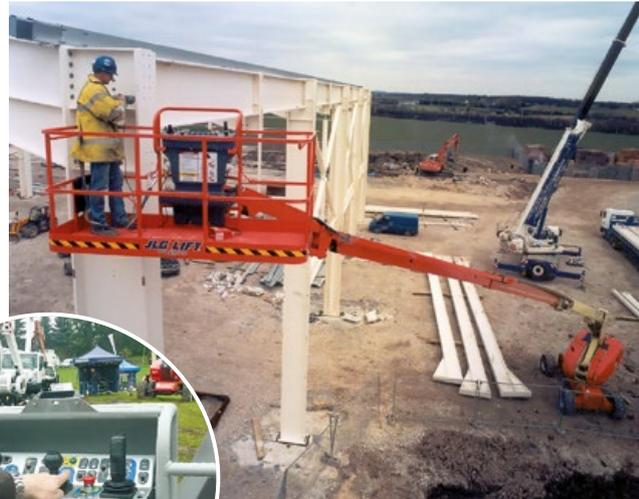
**Stillstand:** Angekommen in der Arbeitsposition, könnten unbeabsichtigte Maschinenbewegungen zu gefährlichen Situationen führen. Damit die Bühne während der Arbeit nicht aus Versehen bewegt werden kann, wurde bislang oft die Not-Aus-Taste zweckentfremdet. Ist die Maschine mit einer „Motor ein/aus“-Steuerung an der Plattformsteuerung ausgestattet, muss diese verwendet werden.
