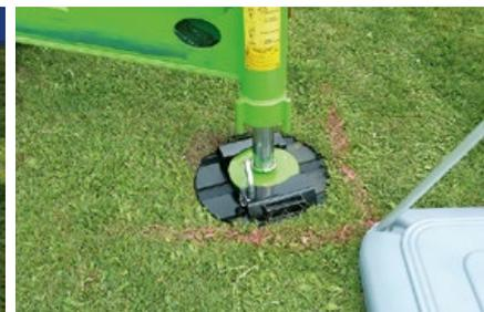
**Nutzlos:** Durch die beim Betrieb entstehenden Bewegungen verändern sich Stützkräfte, wodurch vor allem auf geneigten Flächen und bei Nässe die Stützen von den Unterlegplatten rutschen können. Ohne deren Lastverteilung ist auf gering tragfähigem Grund dann der Umsturz vorprogrammiert. Sicherer sind fest verbundene Tellervergrößerungen. (Bild: Späth)
