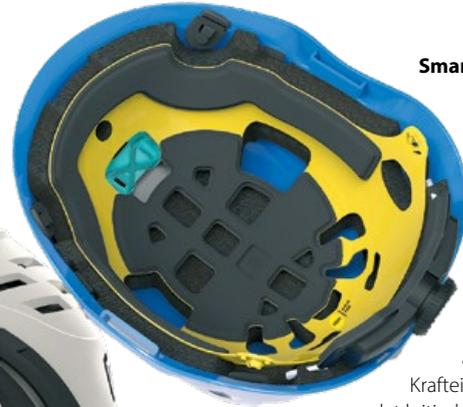
**Mips Sicherheitssystem:** Der neue Industrieschutzhelm aus Schweden verfügt über ein angepasstes Sicherheitssystem, welches bis zu 15 mm Bewegung zwischen Helmschale und Innenteil zulässt. Damit unterstützt dieses den Schutz vor schrägen Schlägen, die unter Umständen zu unterschiedlich schweren Hirnschäden führen können.
