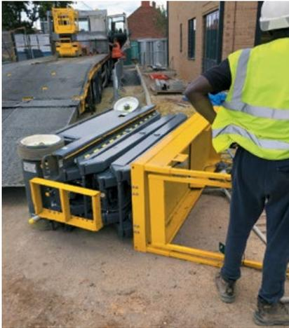
**Flach gelegt:** Vor allem kleine Scherenbühnen mit schmaler Spur können leicht von der Auffahrtrampe kippen, wenn zu schnell gefahren wird oder abrupte Lenkkorrekturen ausgeführt werden. (Bild: Archiv)
