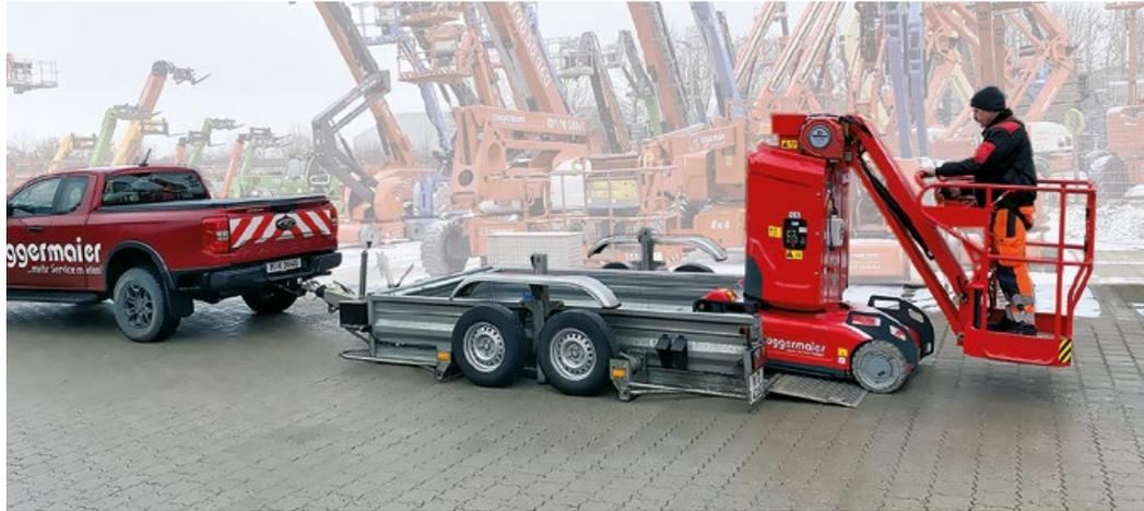
**Kein Absturz:** Eine clevere Lösung ist dieser Tandemanhänger mit komplett absenkbarer Lade­fläche, auf die vollkommen ebenerdig aufgefah­ren werden kann. So bewegt sich der Fahrer auch bei der Ladungssicherung immer auf sicherem Boden und hebt die Lade­fläche erst dann in Fahr­position. Diese Anhänger gibt es bis 5,8 Tonnen Nutzlast – völlig ausreichend für kleinere Maschinen. (Bild: Heimann)
