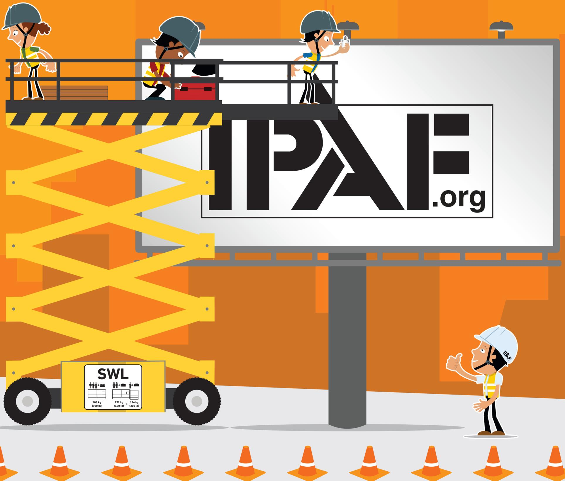
**PLATAFORMAS SOBRECARREGADAS PODEM SE TORNAR INSTÁVEIS; SEMPRE ENTENDA OS LIMITES DA MÁQUINA ANTES DE OPERAR. DISTRIBUA A CARGA UNIFORMEMENTE PARA EVITAR TOMBAMENTOS.**
