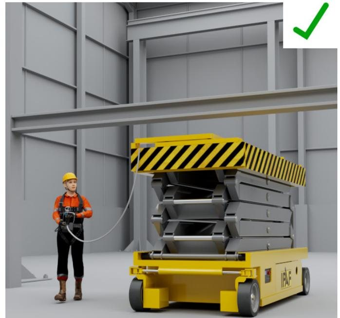
Quando não houver riscos suspensos, o local mais seguro para se ficar é sobre a plataforma, com os dois pés no chão. O controle pedonal só deve ser considerado quando houver um risco suspenso ou para fins de (des)carregamento, quando necessário.
