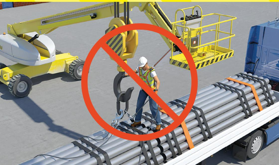
As plataformas elevatórias móveis de trabalho (PEMTs/PTAs) são projetadas para elevar as pessoas a uma posição em que possam trabalhar em altura com segurança na plataforma. As PEMTs/PTAs não são projetadas para serem usadas como um ponto de ancoragem suspenso. Usá-las como tal **não é recomendado**.
