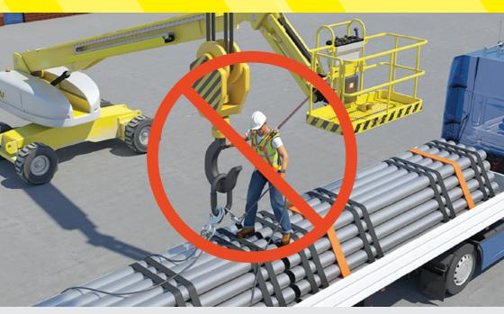
Las plataformas elevadoras móviles de personal (PEMPs/PTAs) están diseñadas para elevar a las personas a una posición donde puedan trabajar en altura de forma segura en la plataforma. Las PEMPs/PTAs no están diseñadas para ser usadas como un punto de anclaje elevado. **No se recomienda** utilizarlas como tal.
