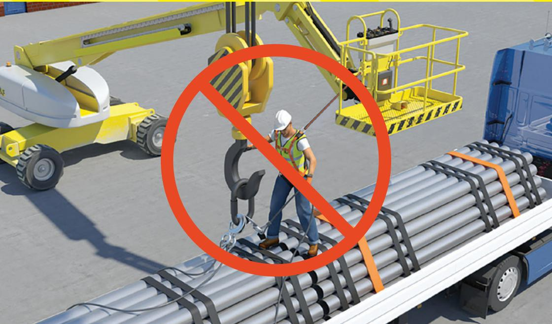
Mobile Hubarbeitsbühnen sind so konzipiert, dass sie Menschen in eine Position heben, in der sie sicher Höhenarbeiten auf der Plattform durchführen können. Hubarbeitsbühnen sind nicht für die Verwendung als Überkopf-Verankerungspunkt ausgelegt. Ihre Verwendung als solche wird **nicht empfohlen**.
