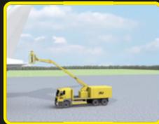
Dies sind alle Maschinen des Typs 2 (Fahren mit angehobener Plattform, von der Basis aus gesteuert) und spezielle MEWPs. Aufgrund ihrer einzigartigen und oft maßgeschneiderten Konstruktion erfordern sie eine spezielle Ausbildung während der Bedienschulung für MEWPs.
