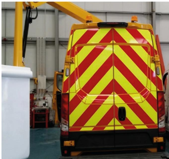
*Figura 1: Exemplo de marcações de veículos de alta visibilidade na forma de divisas traseiras.*
