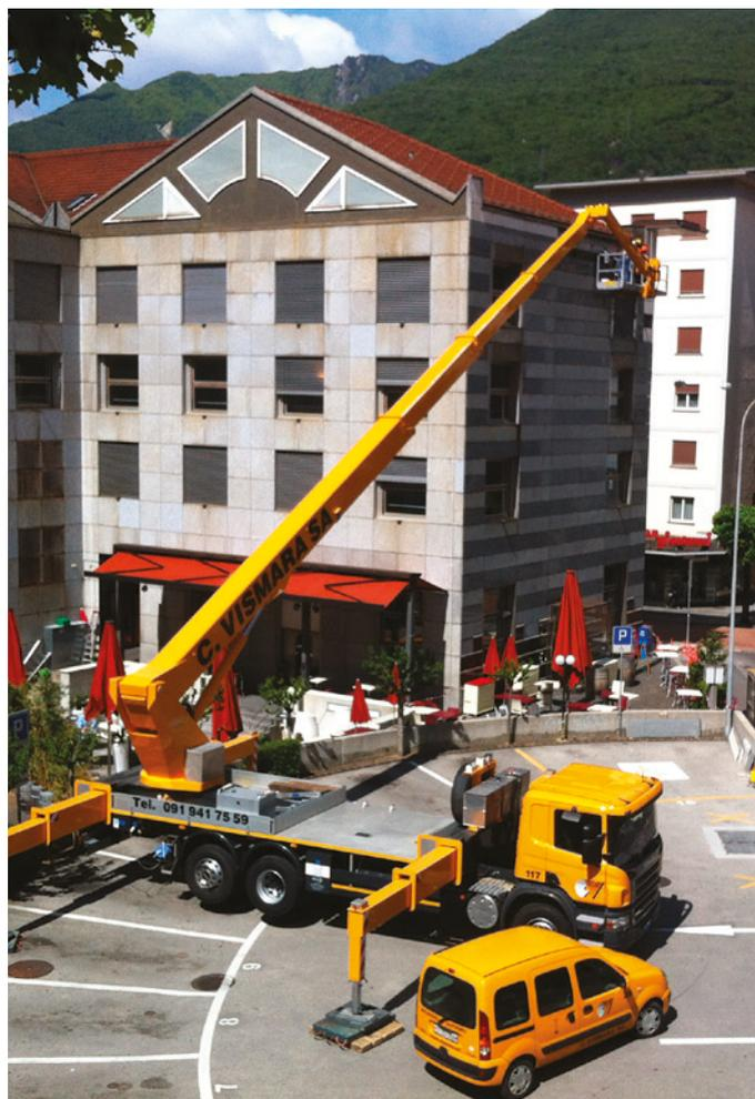
Se a visibilidade do operador for limitada, ou o público estiver invadindo o espaço próximo à PEMT/PTA, deve-se ter presente um agente/observador treinado com roupas de alta visibilidade adequadas para orientar o movimento da máquina e controlar o movimento dos pedestres. Deve haver um método de comunicação acordado entre o operador e o agente/observador treinado.
