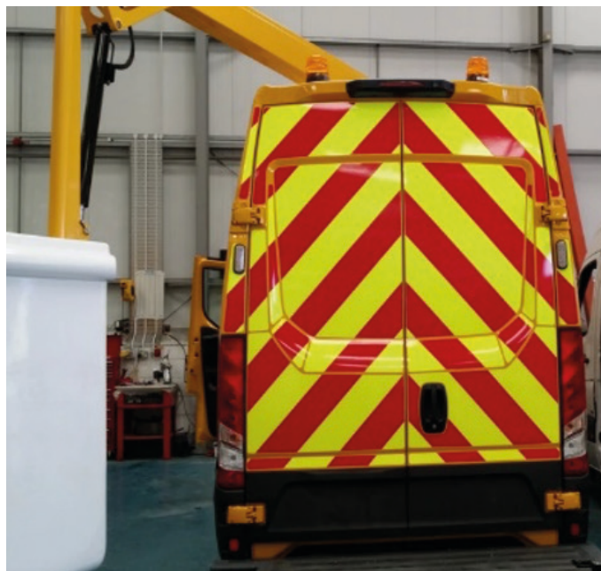
Figura 1: Ejemplo de marcas de alta visibilidad angulares en la parte trasera.
