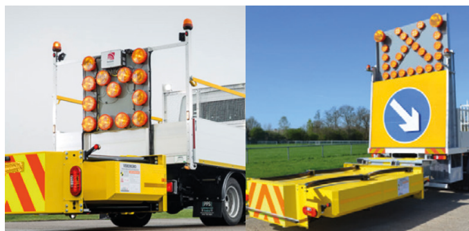
Figuras 2 y 3: Ejemplos de vehículos con protección frente a impacto utilizados para avisar a otros usuarios de la vía de la presencia de vehículos de trabajo en la carretera o cerca de ella, informar a los conductores y reducir la gravedad de las lesiones en caso de colisión entre un usuario de la carretera y un vehículo de trabajo.
