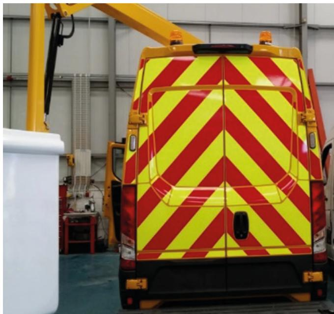
**Bild 1:** Beispiel für gut sichtbare Fahrzeugmarkierungen am Heck.
