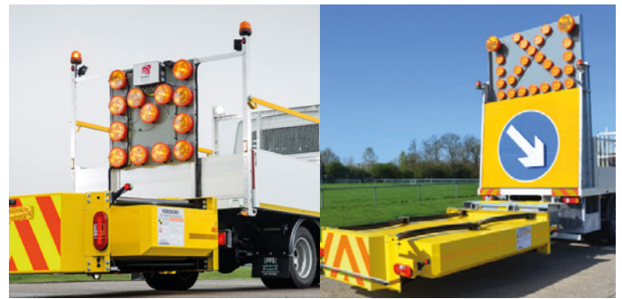
그림 2와 3: 충격 방지 기능이 장착된 차량의 예는 도로에서 또는 바로 옆에서 작업하는 차량을 다른 도로 사용자에게 알리고 운전자에게 적절한 정보를 제공하며 도로 사용자가 작업 차량과 충돌할 경우 부상의 심각성을 줄이는 데 사용됩니다.
