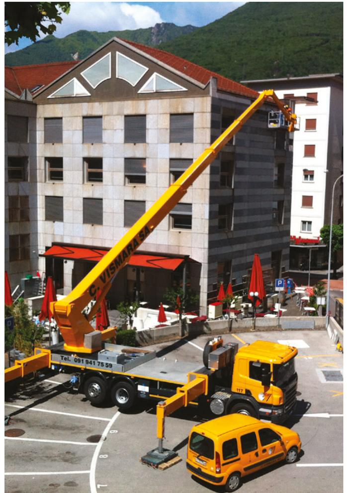
MEWP 应以适当的速度行驶以适应周围的条件 - 附近有行人时必须低速行驶。当机器沿着预定路线前进时,操作员应不断留意机器附近的人员、车辆和障碍物。在操作期间,操作员和指挥员/观察员不得被移动电话(包括免提)、收音机或其他设备分散注意力。不应允许 MEWP 的任何部分侵占实时车道。
