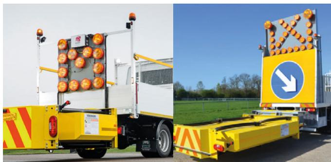
照片 2 和 3: 装有碰撞保护装置的车辆示例，用于提醒其他道路使用者注意在道路上或紧邻道路工作的车辆，为驾驶员提供适当的信息，并在道路使用者与工程车辆发生碰撞时降低伤害的严重程度。
