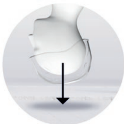
1- I caschi tradizionali sono progettati e testati per gli impatti lineari, mentre la maggior parte degli impatti è obliqua e di conseguenza può provocare un movimento rotazionale della testa.
