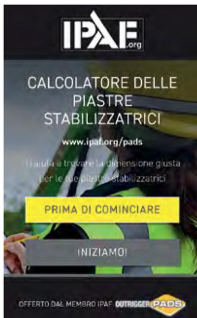
Il calcolatore delle piastre di appoggio IPAF è uno strumento interattivo semplice, concepito per aiutare gli operatori e il personale incaricato di determinare la dimensione delle piastre di appoggio da utilizzare in fase di allestimento di una PLE per supportare interamente il peso sugli stabilizzatori. Una volta inserito il peso lordo della PLE, il convertitore mostra l'area minima delle piastre di appog-
