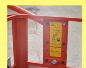
La UNE-EN 280 indica que se deben tener previsto uno o más anclajes para la unión de un dispositivo de fijación y deben estar diseñados para retener el equipo de protección individual. (No es un punto anticaídas)
