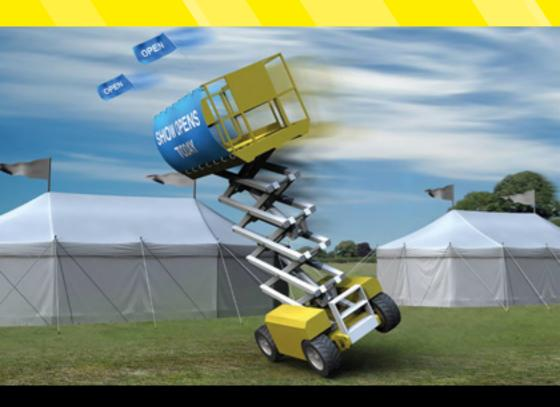
Molte piattaforme a pantografo sono progettate esclusivamente per l'uso in ambienti interni e in assenza totale di vento. Anche all'esterno, in caso di raffiche o forte vento, la piattaforma sollevata può venir ribaltata. Le piattaforme a pantografo non sono concepite per portare striscioni pubblicitari. Il fissaggio di uno striscione alla piattaforma a pantografo aumenta la superficie della stessa e crea l'effetto vela, che può destabilizzare o ribaltare la PLE.
