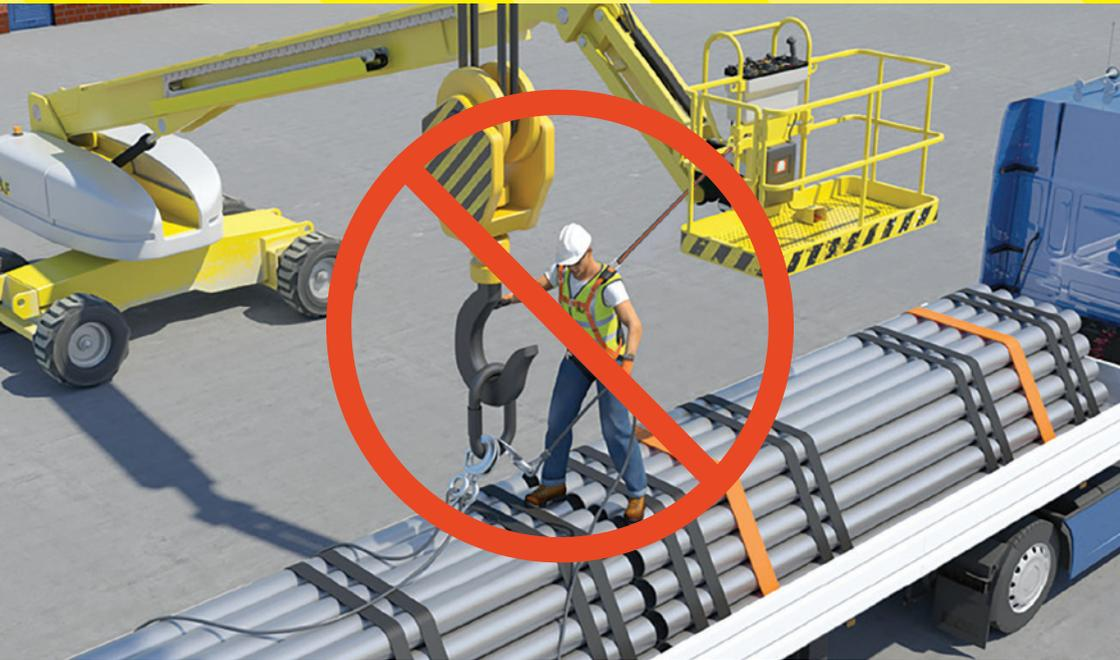
Les plateformes élévatrices mobiles de personnes (PEMP) sont conçues pour soulever les personnes à un niveau où le travail peut se faire à l'intérieur de la plateforme en toute sécurité. Les PEMP ne sont pas conçues pour être utilisées comme point d'ancrage en hauteur. Leur utilisation en tant que tel n'est **pas recommandée**.
