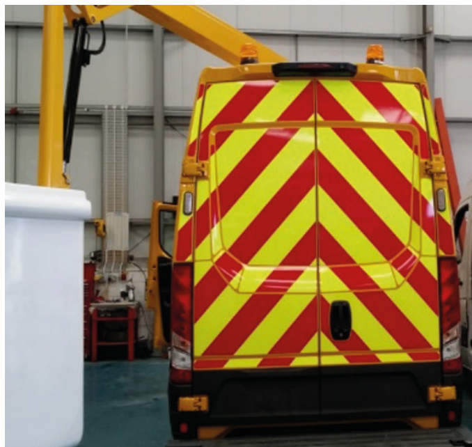
Photo 1 : Exemple de marquage à haute visibilité des véhicules sous forme de chevrons arrière.
